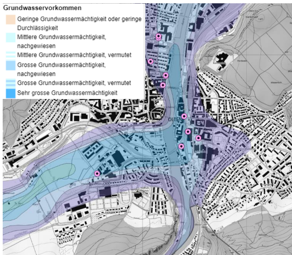
Abbildung 9 Bestehende Grundwasserwärmepumpen (rosa), Grundwassermächtigkeit (türkis 40-50 m, dunkelblau 30-40 m (Quelle: Grundwasserkarte des Kantons Solothurn).
