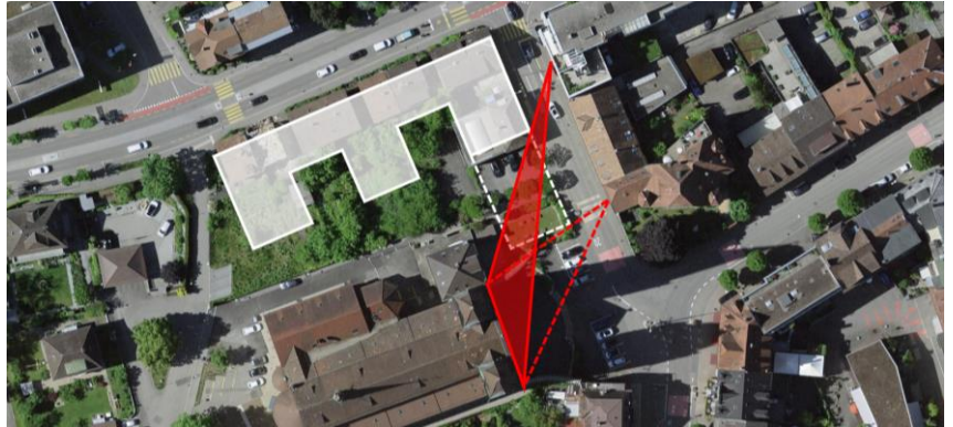
Abbildung 26: Luftbild mit Darstellung der heutigen Baufeldbegrenzungen (weiss) und der früheren Ausdehnung entlang der Ziegelfeldstrasse (gestrichelt). Dank der Reduzierung des östlichen Querriegels wird die Kirchenfront bei der Einfahrt in die Bleichmattstrasse schon früh in ihrer Gesamtheit erkennbar 43
