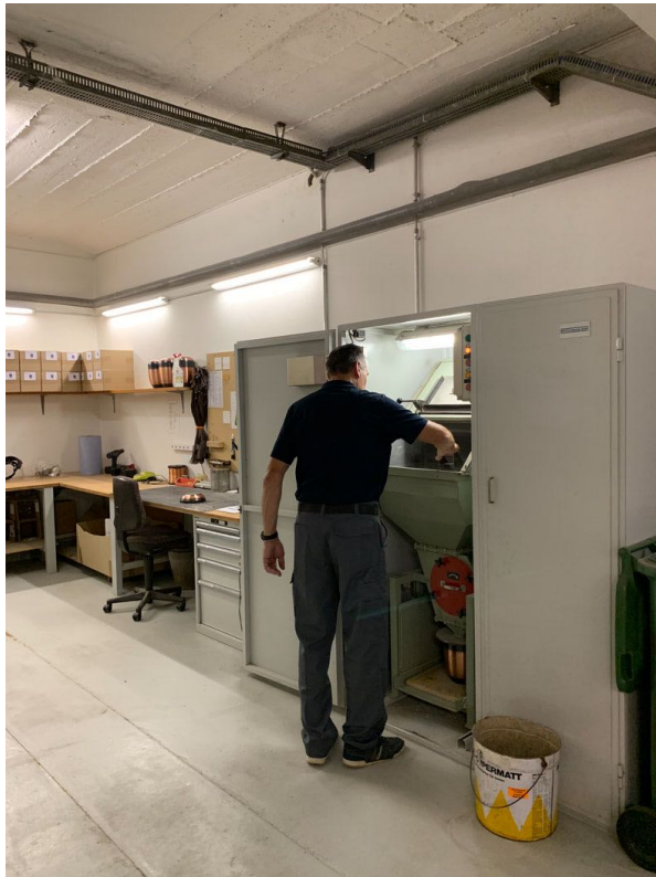
Abbildung 7: Aschemühle mit Staubabsaugung im rechten Schrankfeld
