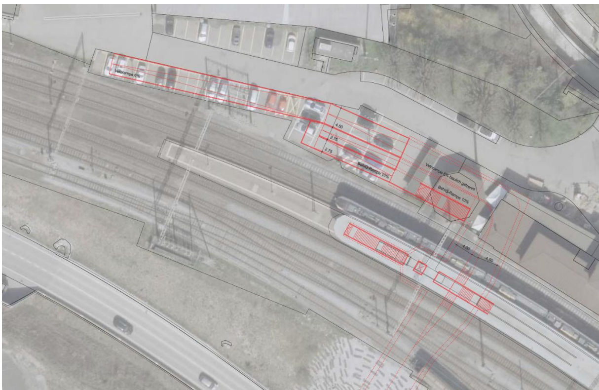
Abb: Variante Kurz mit baulich getrennten Rampen für den Fuss- und Radverkehr
