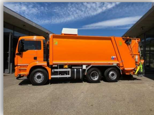
Kehrichtfahrzeug FARID mit elektrischem Presswerk Aufbau
