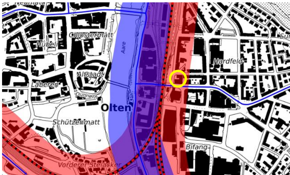
Abbildung 1: Konsultationsbereiche der störfallrelevanten Anlagen in der Umgebung des Bauprojekts gemäss Geoportal des Kantons Solothurn. Das zu überbauende Areal (gelber Kreis) befindet sich im Konsultationsbereich der angrenzenden Bahnlinie (rot).
